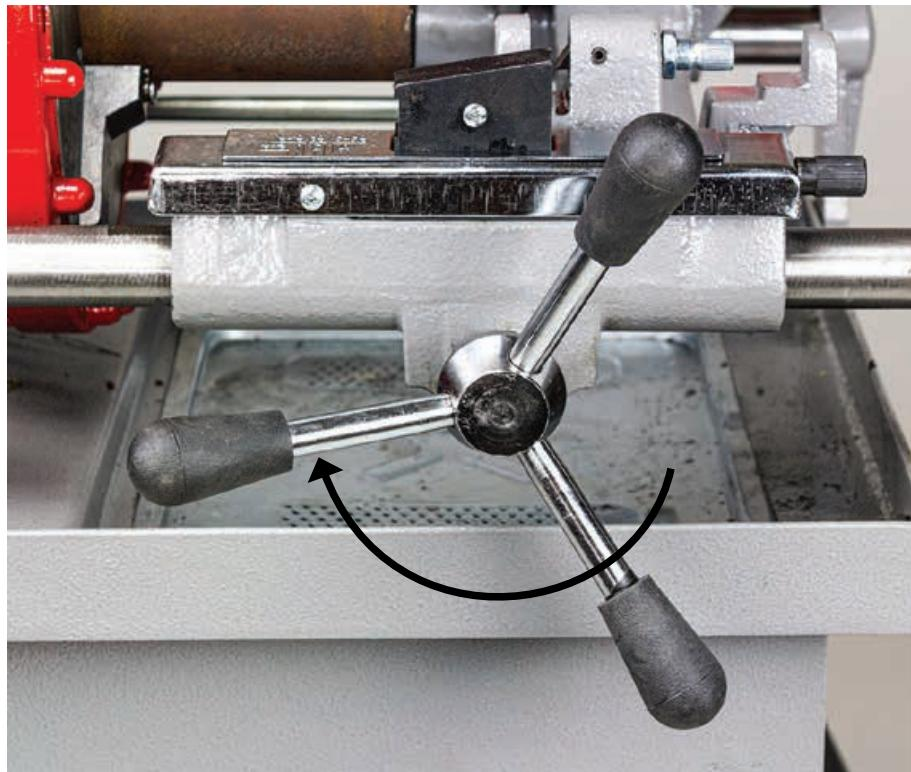
Опустите труборез на обрабатываемую деталь и включите станок выключателем.
