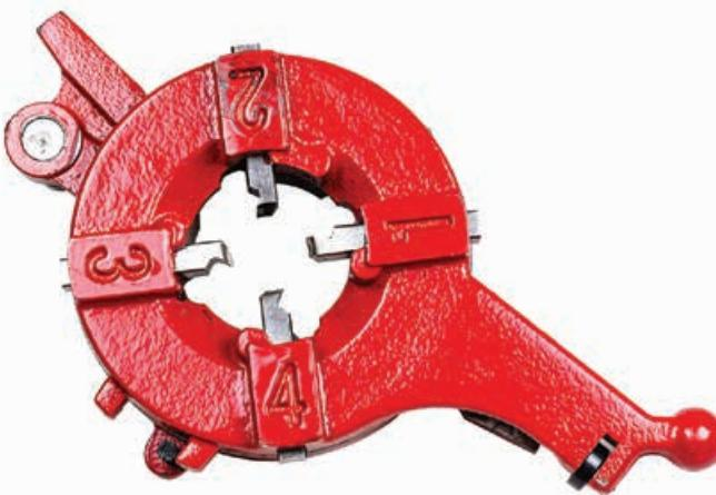
ее на горизонтальную плоскость цифрами вверх. Повернуть рукоятку потив часовой стрелки до упора. Вытащить ножи.
