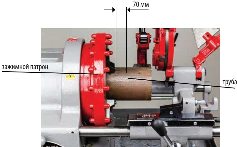
Поднимите труборез (1), резьбонарезную головку(2) и гратосниматель (3) так, чтобы они не мешали. Введите обрабатываемую деталь через центрирующий зажимной патрон (7) и затяните его.
