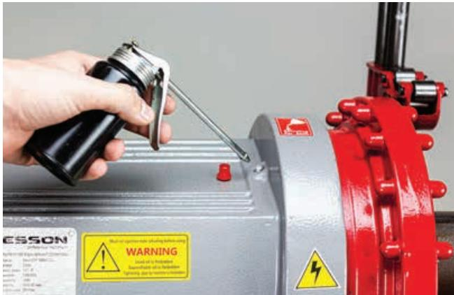
кратное 1-2 мл! Частота заливки масла (смазывания) зависит от объема и интенсивности выполняемых работ.
